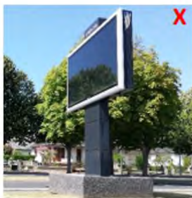
Dispositif de scellement non enterré
